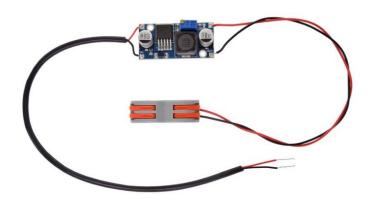
LMPS-MP2 - DC converter, In: 9-36V, Out: 5V 1A.
